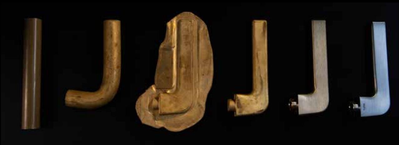
Jeder Türgriff wird in einem modernen, integrierten technologischen Prozess hergestellt, der Schritte wie Schmieden, Druckguss, Entgraten, Polieren und schließlich das markentypische Galvanisieren umfasst, wodurch mehr als 150 verschiedene Oberflächen hergestellt werden können.
